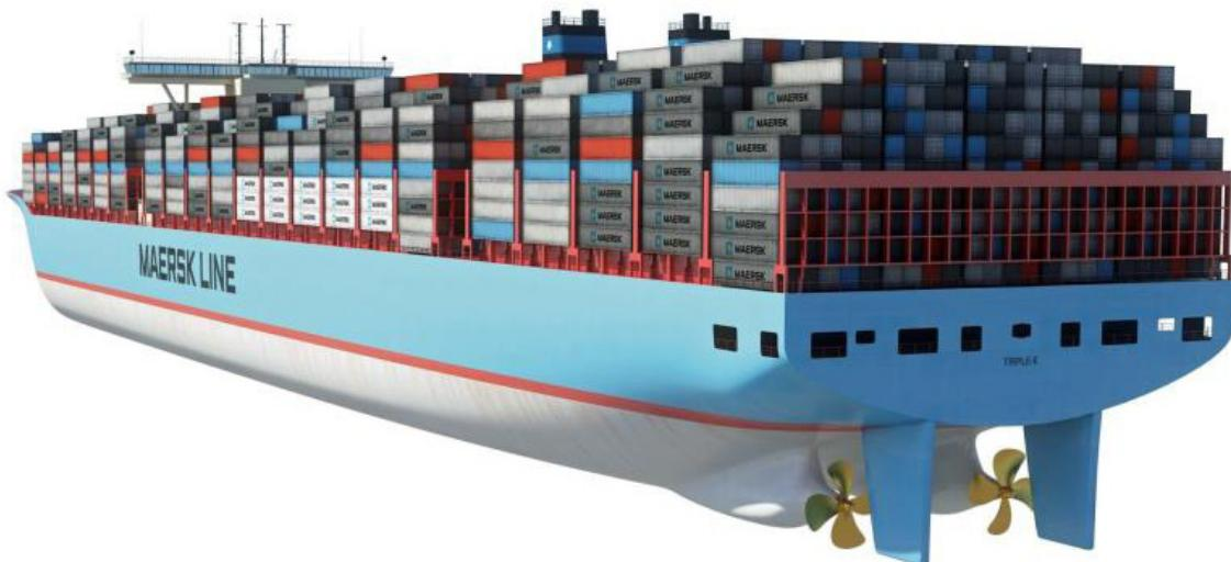
Brodovi osme generacije (od 20.000 do 24.000 TEU) priklanjaju se jednovijčanoj propulziji jer moguće je da zbog povećane oplakane površine (skegova), te povećanog otpora drugog vijka i drugog lista, dvovijčana propulzija nije dala očekivane uštede.
