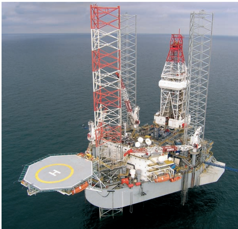
Slika 2. Samopodizajuća platforma „Saturn“ Jack-up
