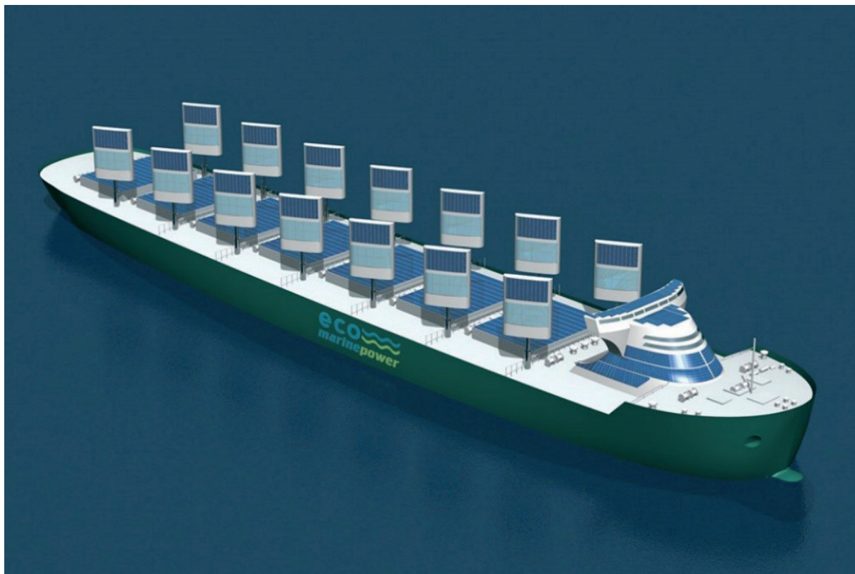
Slika 15. Ekobrod koji istodobno koristi energiju sunca i energiju vjetra [23]
