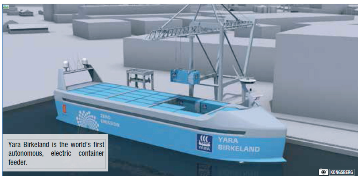
Slika 2: Yara Birkeland, prvi na svijetu autonomni, električni brod za prijevoz kontejnera [1]
