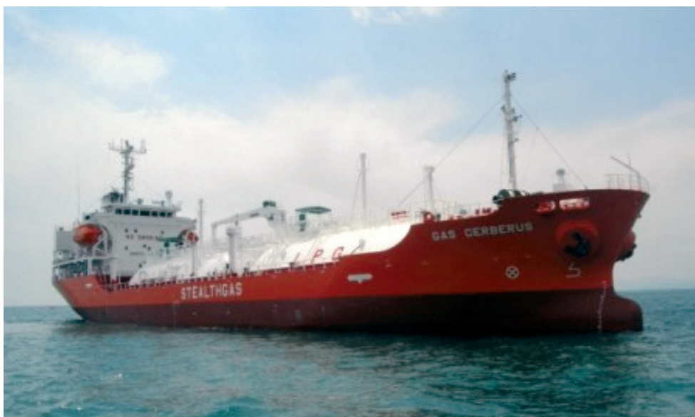
Slika 2. LPG brod za prijevoz polupothlađenog ukapljenog plina
