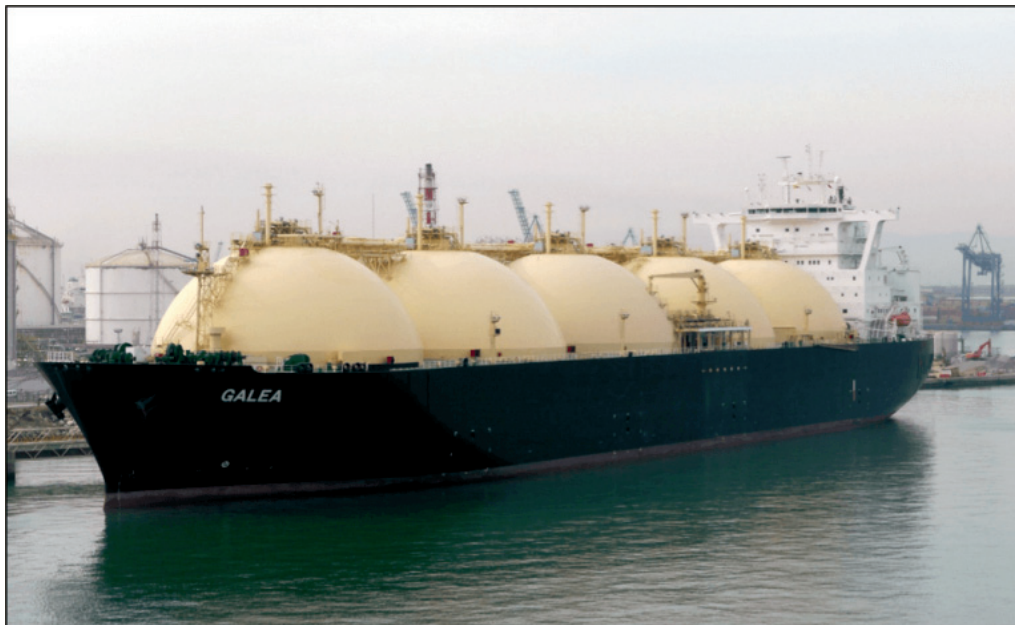
Slika 3. LNG brod za prijevoz potpuno pothlađenog plina
