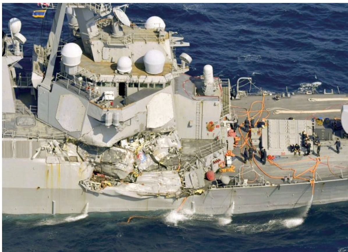
Slika 1: USS Fitzgerald: Oštećenje naneseo bulbom se ne vidi jer je ispod površine
