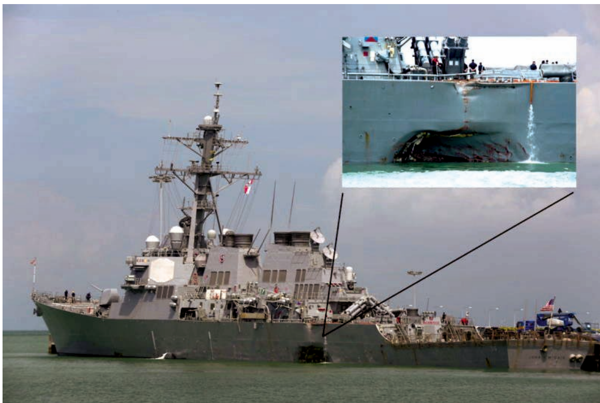
Slika 2: USS John S Mc Cain: Oštećenje naneseo bulbom je u razini vodene linije i dobro se vidi (manja slika)
